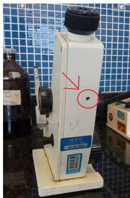
Imagem 2 - Localização do parafuso a ser ajustado na calibração do equipamento
